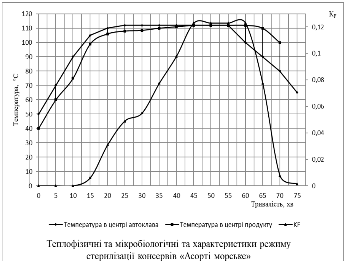
Рис. 1.6 - Теплофізичні та мікробіологічні та характеристики режиму стерилізації консервів «Асорті морське» за режимом \frac{5-15-35-20}{112} \cdot 0,16 \text{ мПа}
