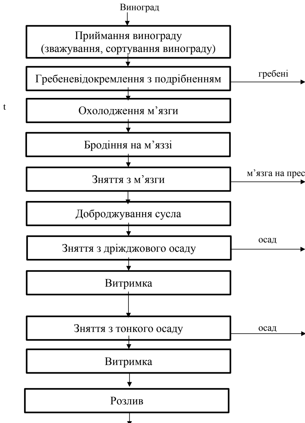
Рис. 4.1 – Принципова технологічна схема виробництва натуральних червоних вин
