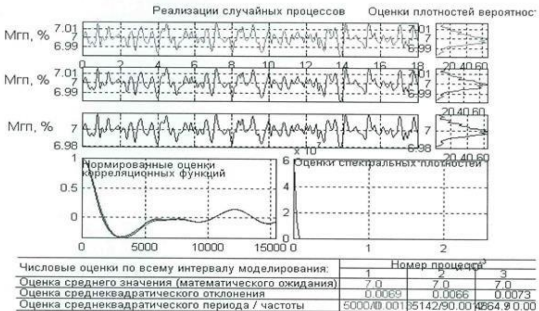
Рис. 2.31 – Результаты моделирования САР с ПИ-регулятором каналу вмісту вологи.
