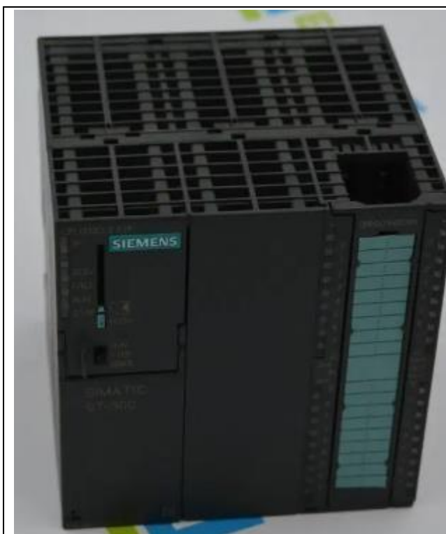
Рис 5.19. Контролер програмований SIMATIC S7-300, CPU313C-2DP
