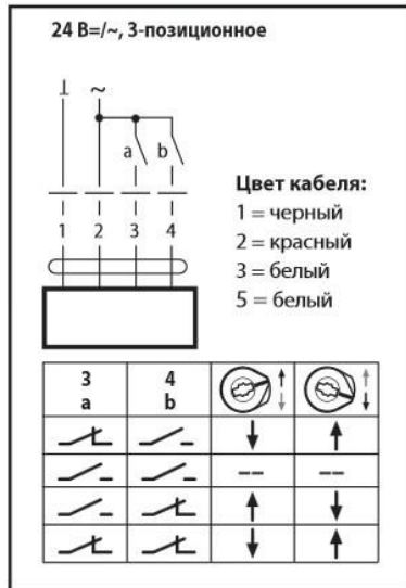
Рис 5.6 Схема підключення Виконавчий механізм Velimo AVK24A
