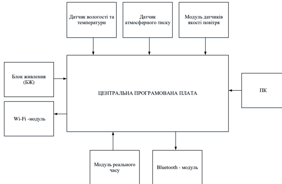
Рисунок 1.7 – Структурна схема системи клімат-контролю
