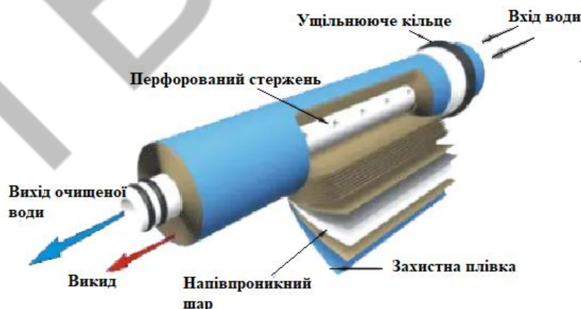
Рисунок 1. Будова зворотньоосмотичного фільтра.
