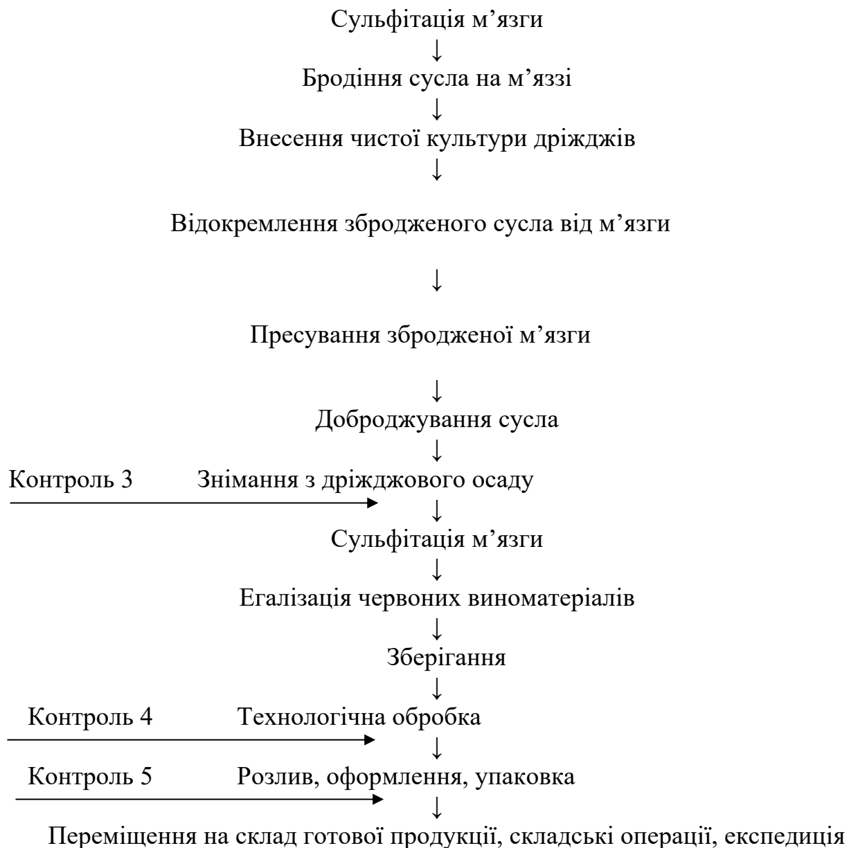
Рис. 4.1 – Технологічна схема виробництва столового вина «по-червоному» способом за класичною технологією з пропозиціями точок контролю
