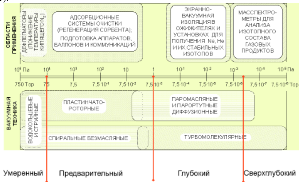
Рис. 1. Область применения вакуумной техники в криогенике.
