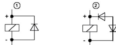
Рис. 3-2. Схемы защиты для катушек, обтекаемых постоянным током
