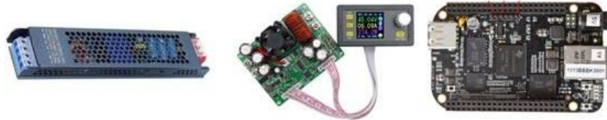
Рисунок 2 - а - блок живлення AC/DC CB-500W-24V; б - перетворювач DC-DC DPS5020; в - одноплатний комп'ютер beaglebone black
