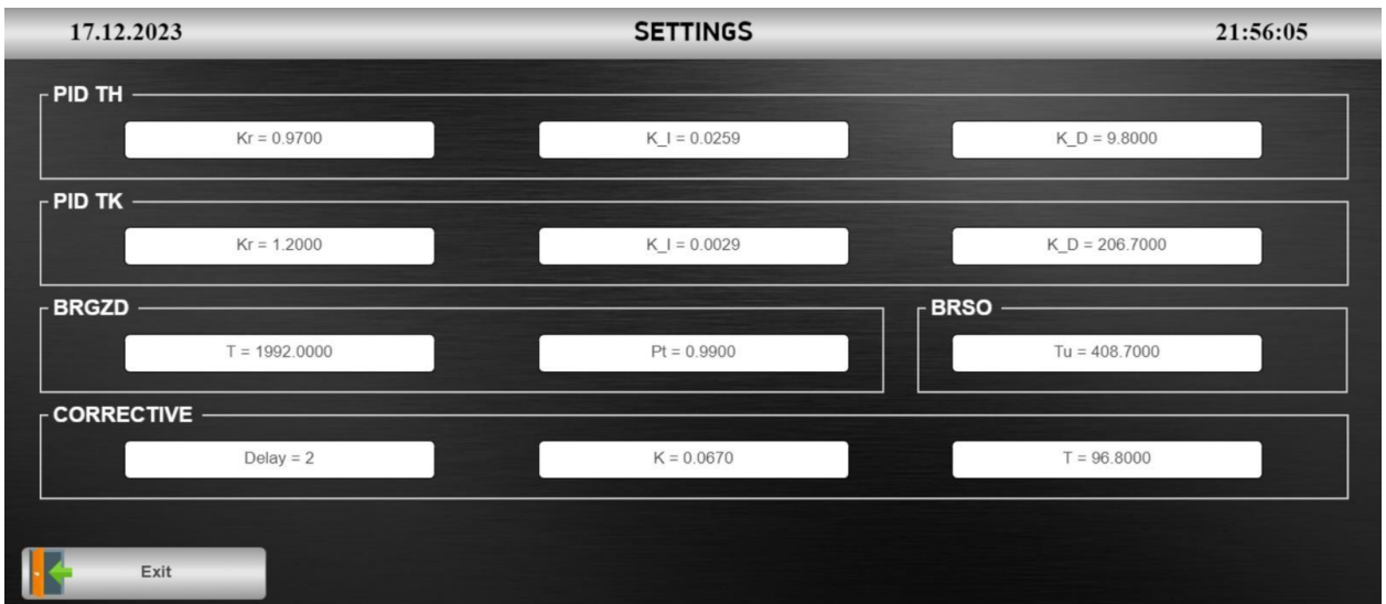
Рисунок 5.23 – Тестування веб-візуалізації вікна, що надає можливість налаштування системи гарантуючого керування процесом каталітичної очистки інертних газів
