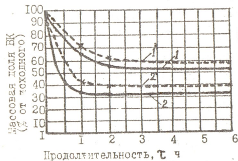
Рис. 3. Влияние температуры на кинетику детартрации модельного раствора ВК и осветленного ВС при обработке диоксидом углерода твердым (4 %):
