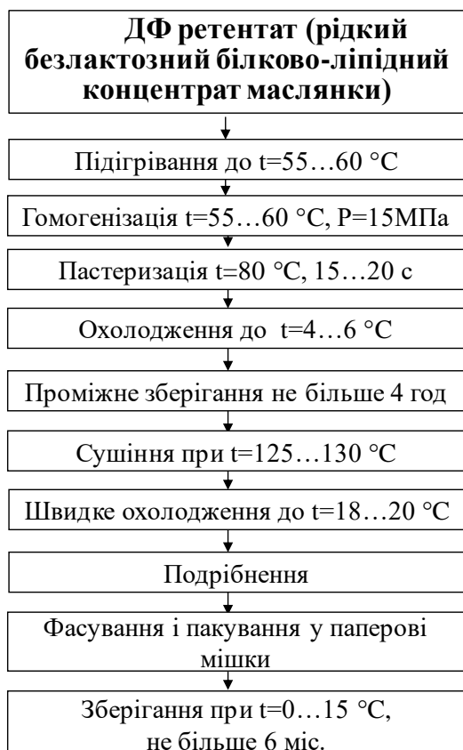
Рис. 7. Технологічна схема виробництва сухого безлактозного білково-ліпідного концентрату маслянки.
