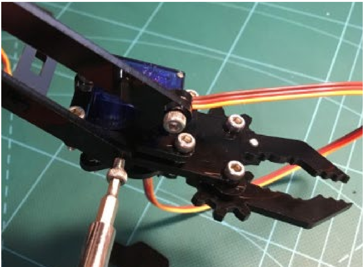
Рисунок 1.27. Етап 5 збірки роботу-маніпулятору
