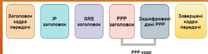
Схема пересилки даних по тунелю PPTP
