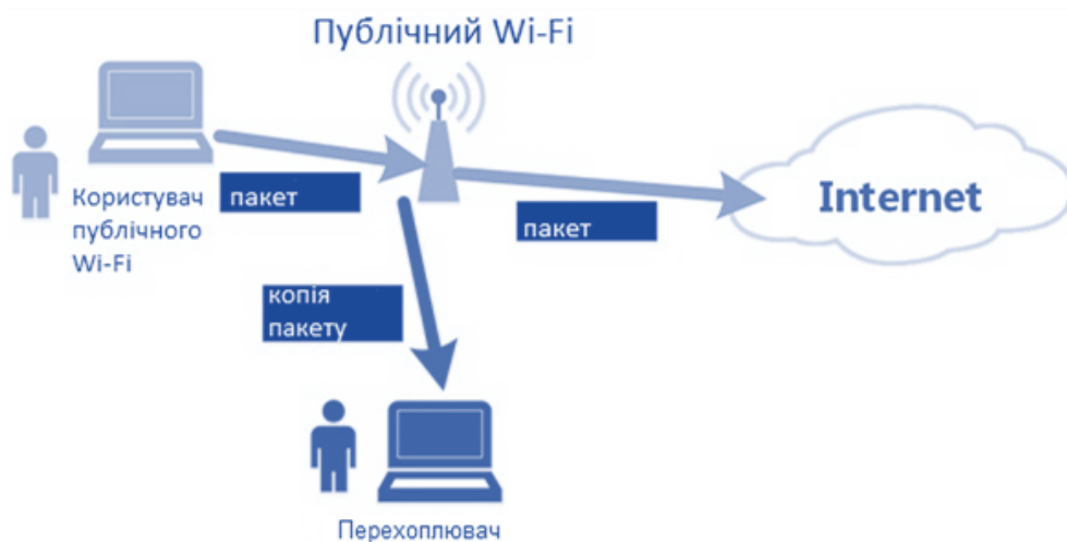
Рисунок 1.32. Схема атаки MITM з перехопленням та аналізом VoIP-трафіку
