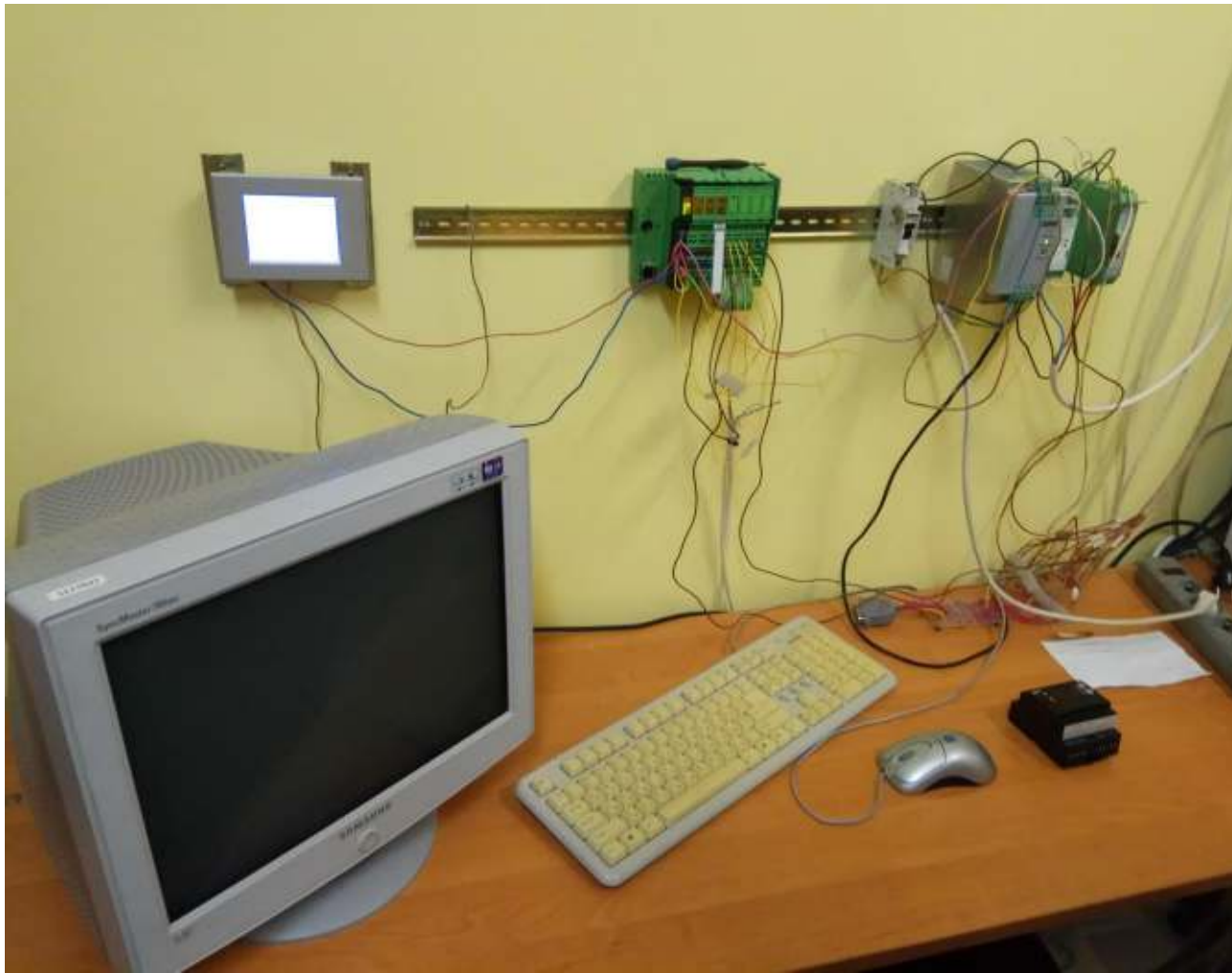
Рис. 3.6. Автоматизована система вимірювань, реєстрації та керування типу «Fenix»
