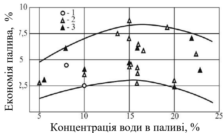
Рис. 1.2. Максимальні значення економії палива, що досягнуті на двигунах різних конструкцій:
