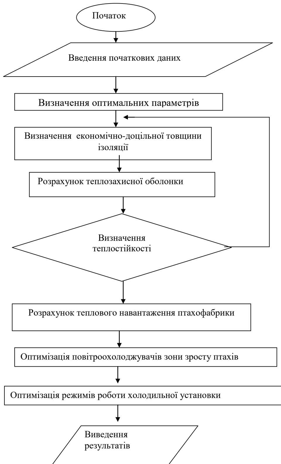
Рис2.1. Блок-схема комплексної оптимізації системи підтримання умов мікроклімату
