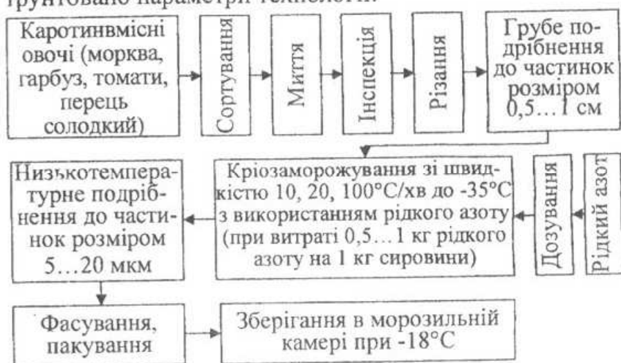
Рис. 12. Принципова технологічна схема виробництва каротиноїдних добавок у формі заморожених поре із каротинвмісних овочів з використанням криогенного заморожування та низькотемпературного подрібнення.
