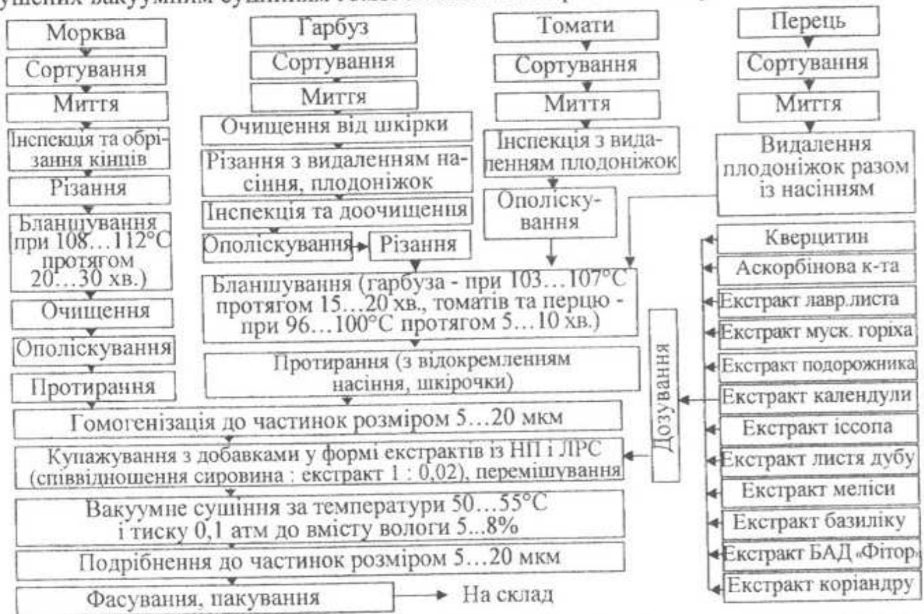
Рис. 11. Технологічна схема виробництва каротиноїдних дрібнодисперсних рослинних добавок у формі порошків (ТУУ 40-01566330-086-2000) із гомогенізованих пюре з КВО.
