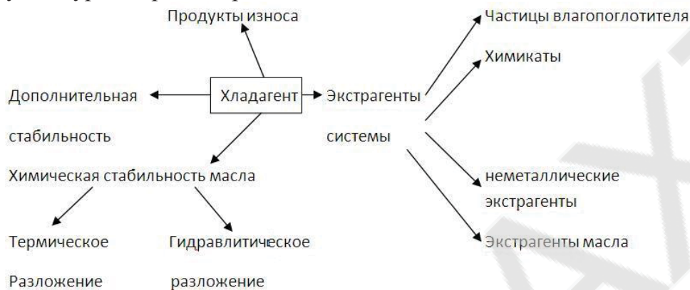
Рис. 1. Схема взаємодія холодоагенту в холодильному контурі (рендл (Randles), 2005)
