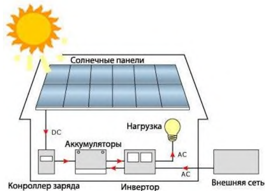
Рисунок 2.4 – Схема електричного живлення від сонячних батарей
