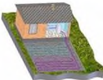
Рисунок 1.5 – Системи для ґрунту горизонтальні
