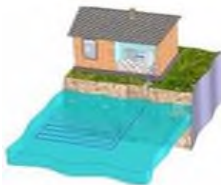
Рисунок 1.4 – Насос із закритим циклом та водорозміщеним теплообмінником
