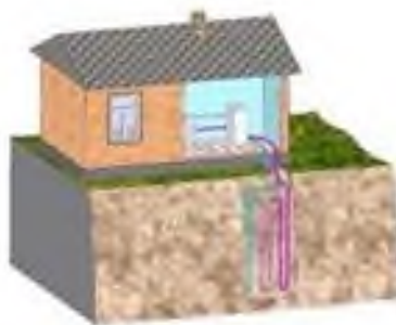
Рисунок 1.6 – Системи для ґрунту вертикальні
