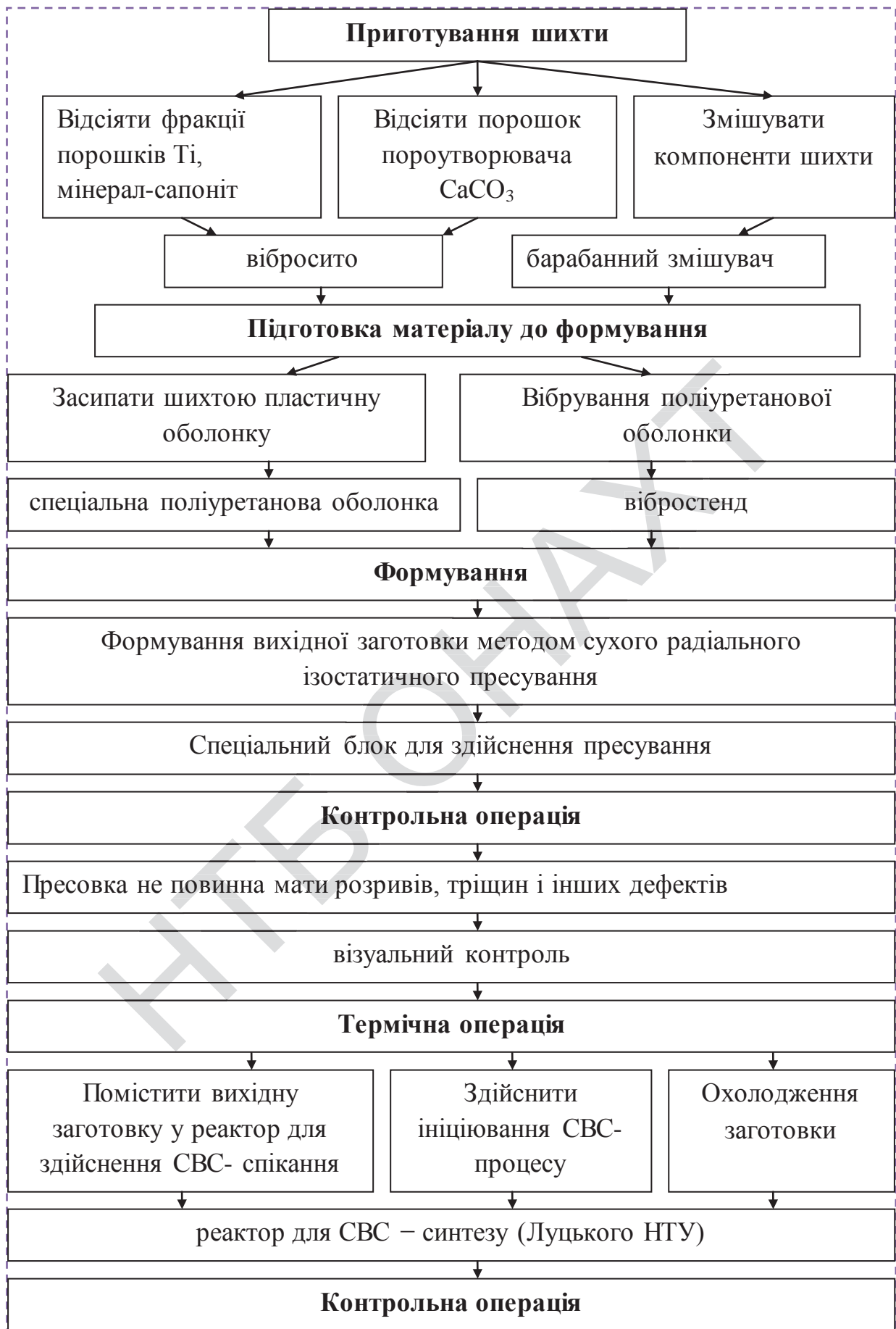
Рис. 1. Технологічна схема методу СВС – процесу
