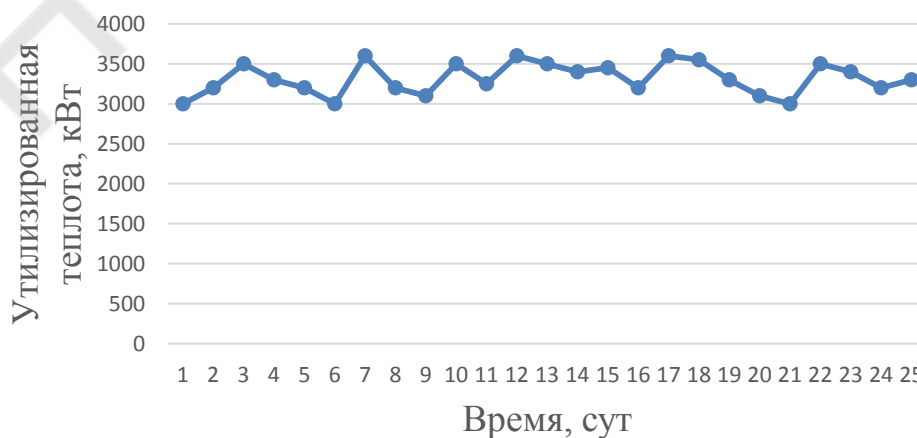
Рис. 1. Теплота, которую можно утилизировать в течение рейса транспортного судна, по маршруту Одесса – Стокгольм
