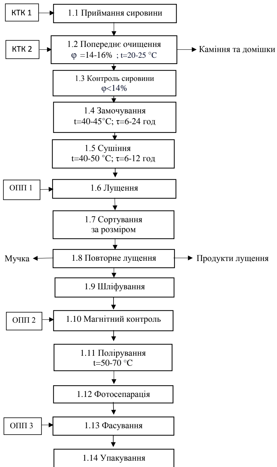
Рис. 2.1 – Блок - схема виробництва крупи рисової шліфованої
