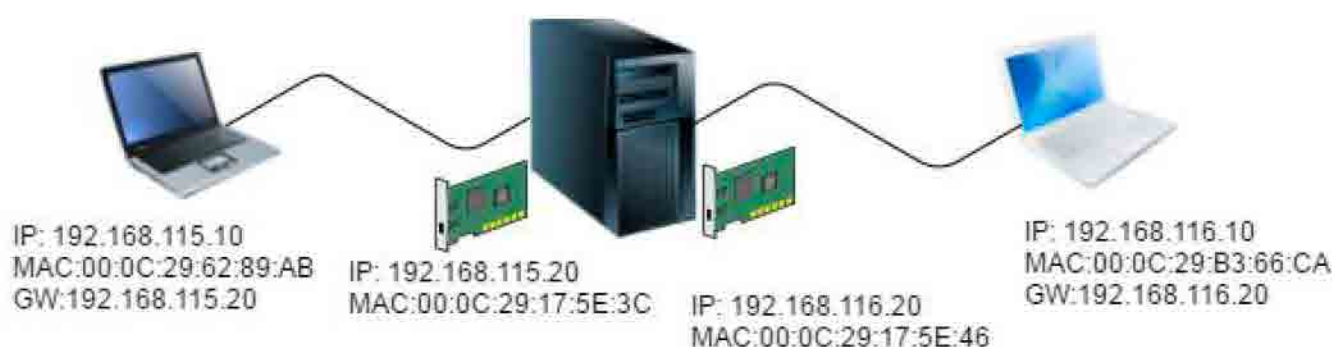
Рисунок 1.8. Схема стенду задля перевірка розроблюваного ПЗ
