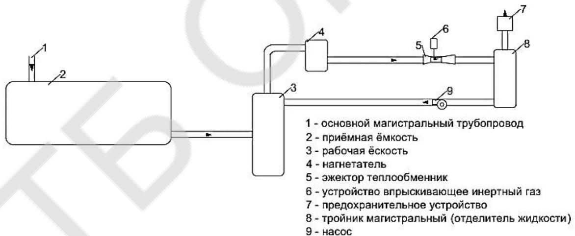
Рисунок 2. Принципова схема підключення ежектора теплообмінника в системі зливу з ємності
