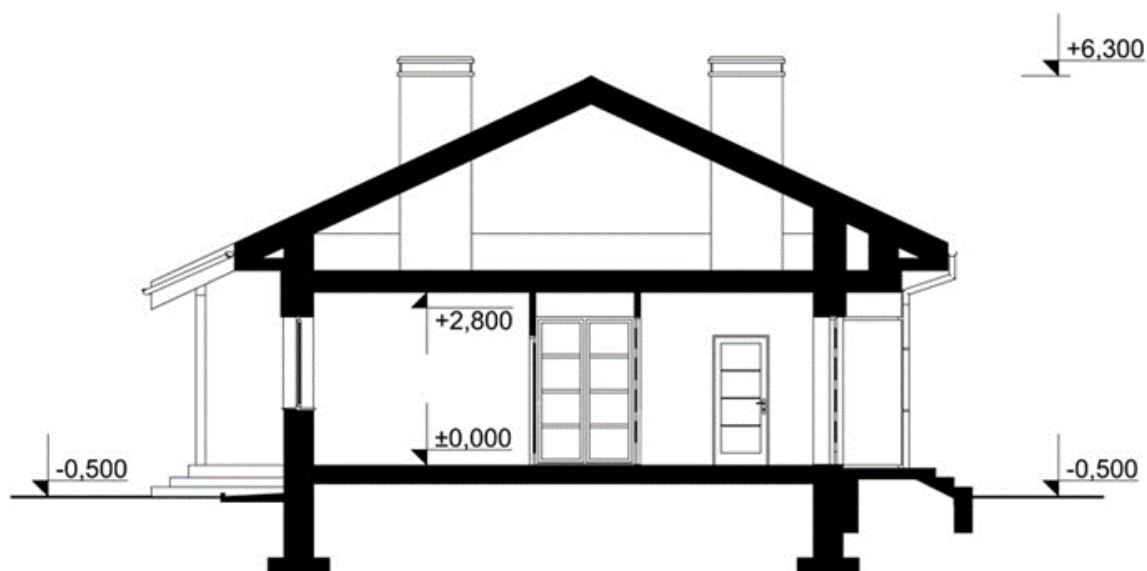
Рис.1.3 Розріз одноповерхового будинку 130 м. кв.
