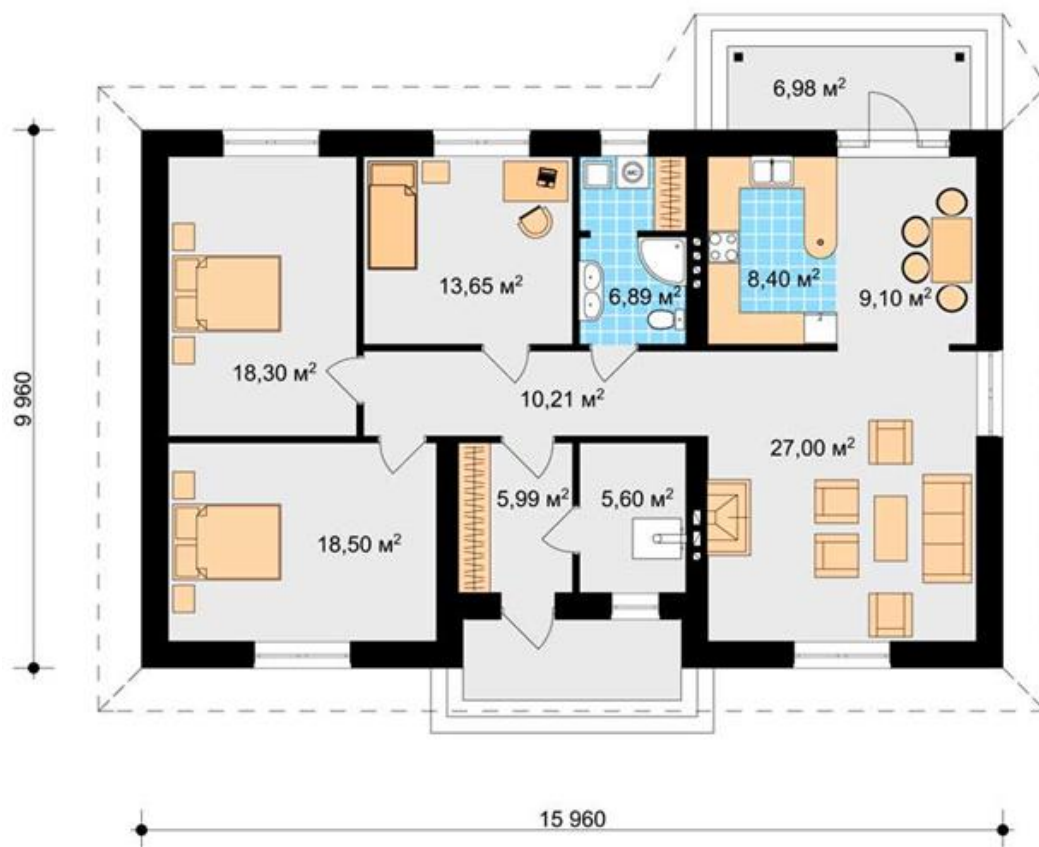
Рис.1.2 План одноповерхового будинку площею 130 м. кв.
