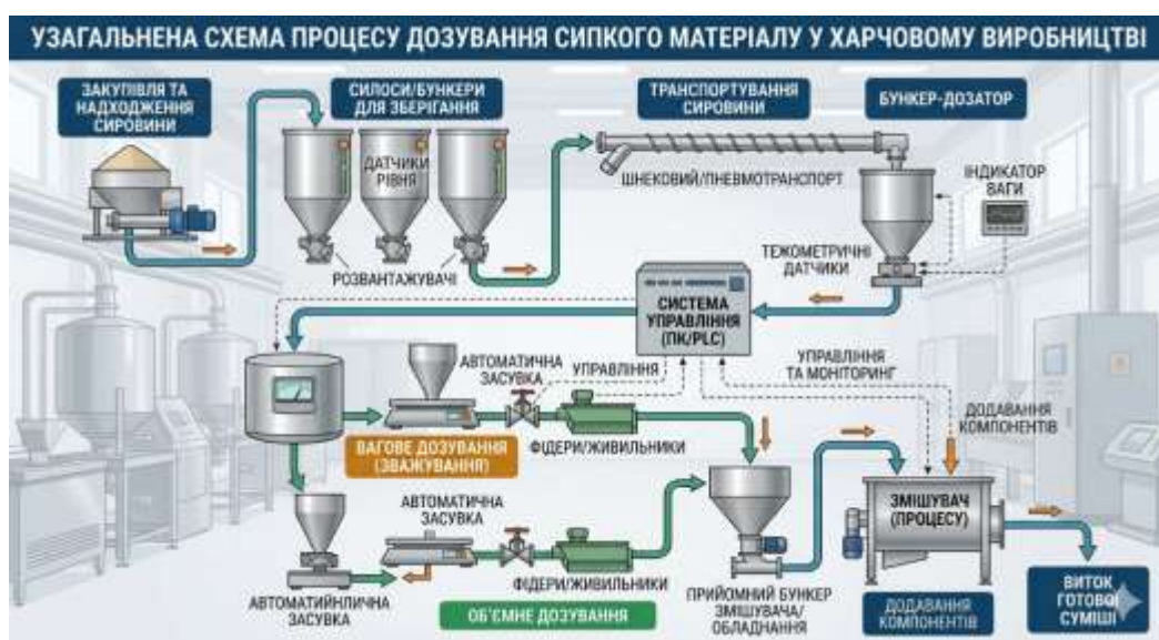
Рис. 1.1 Процес дозування сипкого матеріалу
