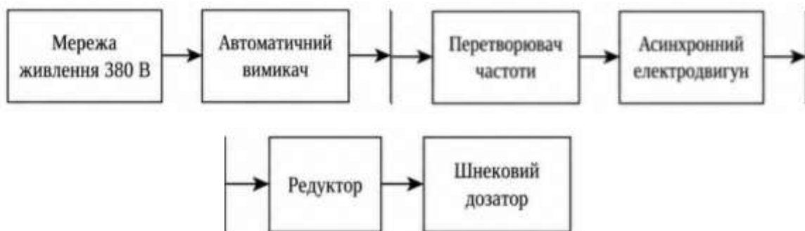
Рис. 3.1 Склад силової частини електропривода
