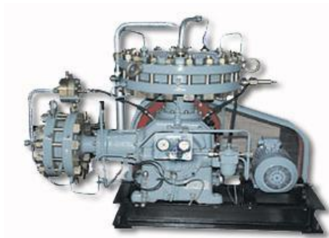
Рис. 1.3. Мембранний компресор високого тиску 1,6 МК
