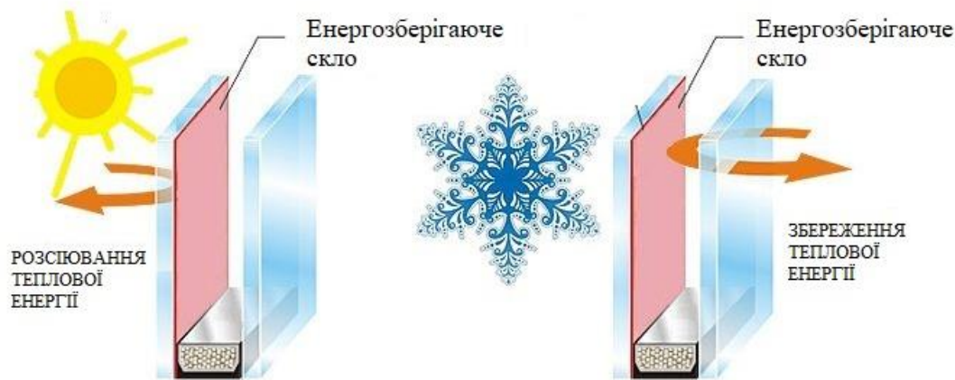
Рисунок 2.3 принцип роботи енергозберігаючого вікна
