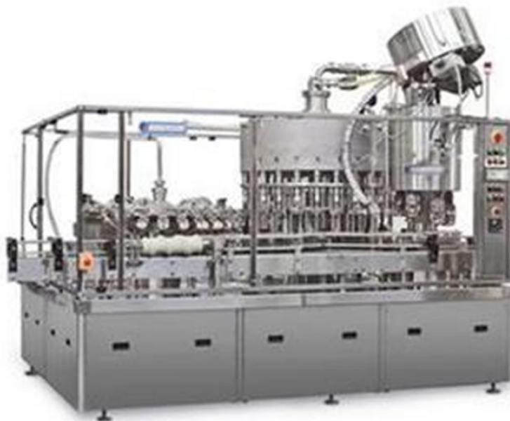
Рис. 5.18. Машина фасувально-закупорювальна з попереднім ополіскуванням для тихих рідин ЛПМ 2.3.
