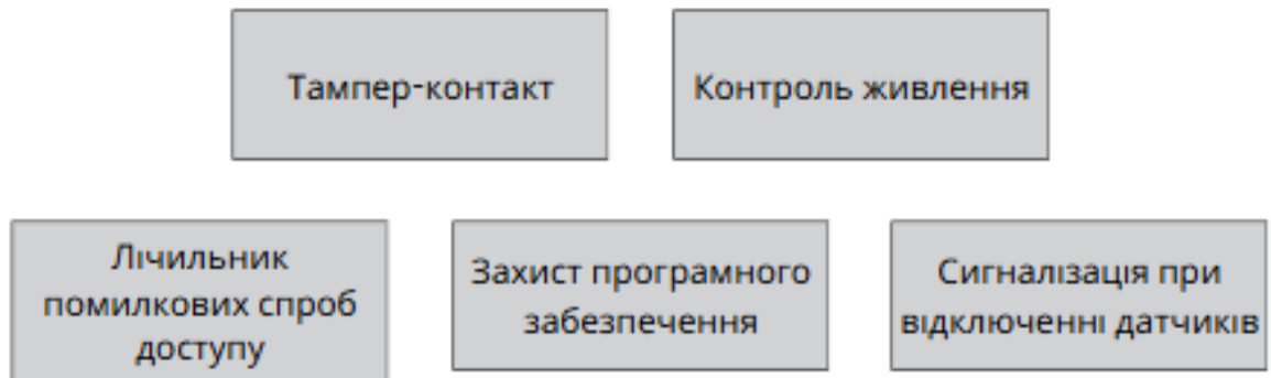
Рисунок 1.10. Можливості реєстрації саботажу системою на базі Arduino
