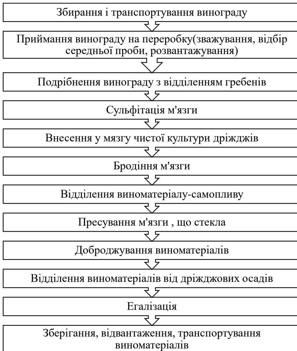
Рис. 3.3 Принципова схема виробництва червоних столових виноматеріалів.
