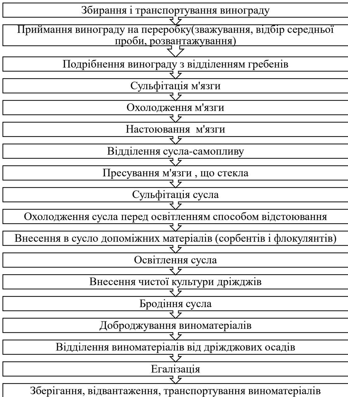
Рис. 3.2 Принципова схема виробництва рожевих столових виноматеріалів.
