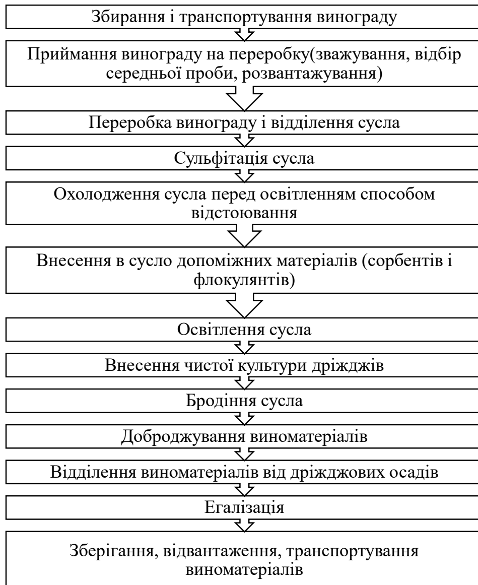
Рис. 3.1 Принципова схема виробництва білих столових виноматеріалів.
