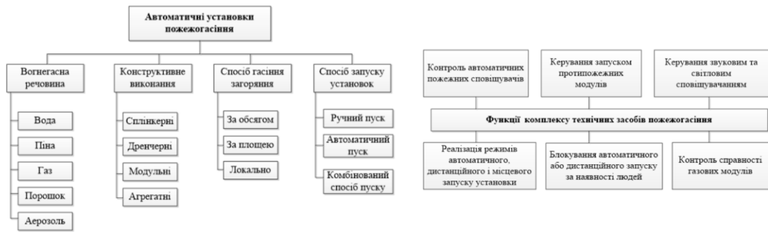
Функції комплексу технічних засобів пожежогасіння
