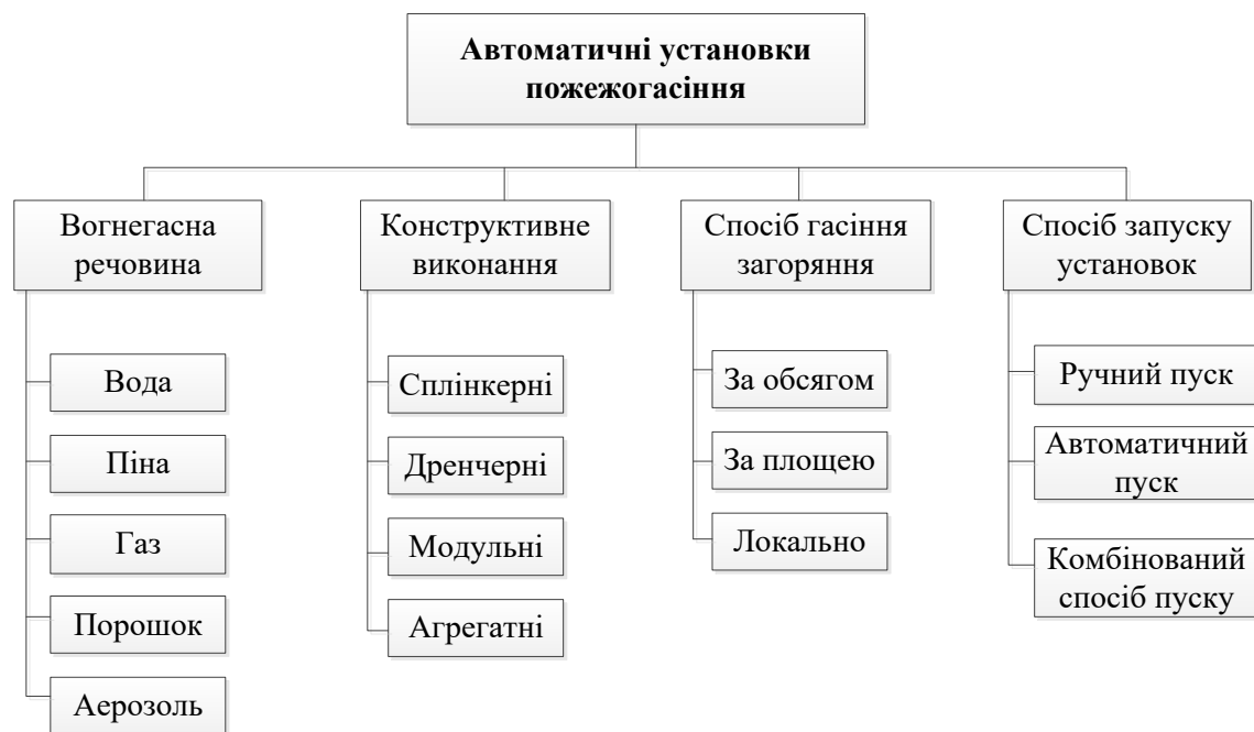
Рисунок 1.7 – Класифікація систем пожежогасіння
