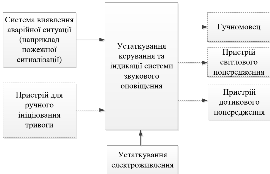
Рисунок 1.9 – Структура системи звукового оповіщення при аварійній ситуації:
