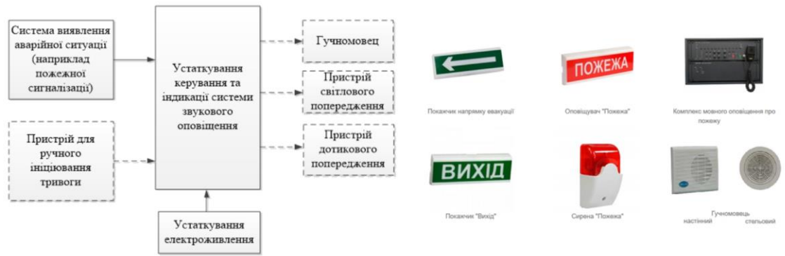
Структура системи звукового оповіщення при аварійній ситуації
