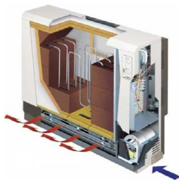
Рисунок 1 – Принцип роботи теплових акумуляторів
