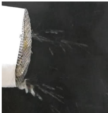
Рис. 3. Процес видалення крапельної вологи
