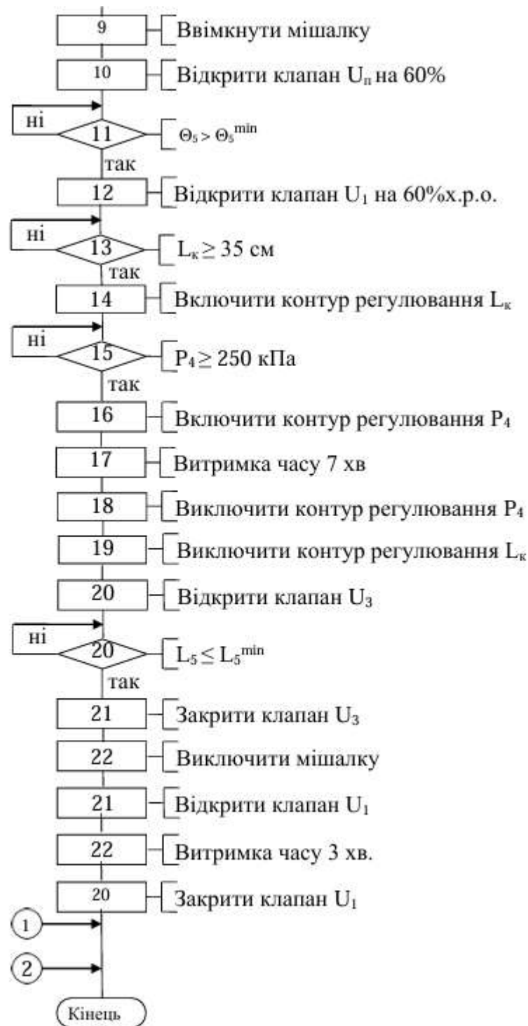
Рис. 4.3 (закінчення) – Блок-схема алгоритму логічного автоматичного керування процесом варки мармеладу
