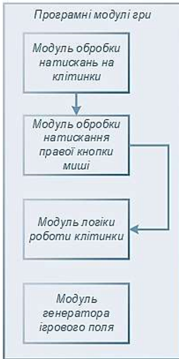
Рисунок 1.7. Перелік програмних модулів для реалізації у розробляємій грі
