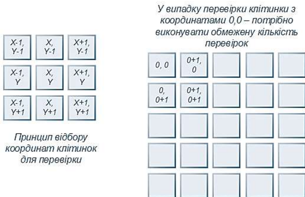
Рисунок 1.20. Приклад виконання перевірки клітинок та обмеженості кількості перевірок у деяких випадках
