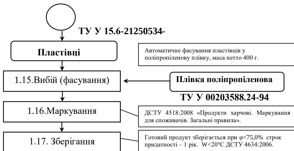
Рис. 3.1 – Блок-схема виробництва пластівців гречаних.
