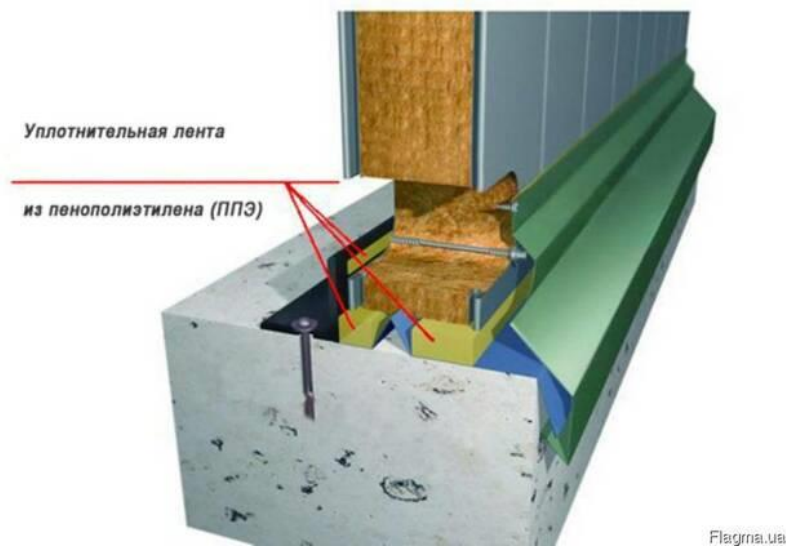
Рис..1.2 Використання ущільнювальної стрічки у вузлі «стіна-фундамент»
