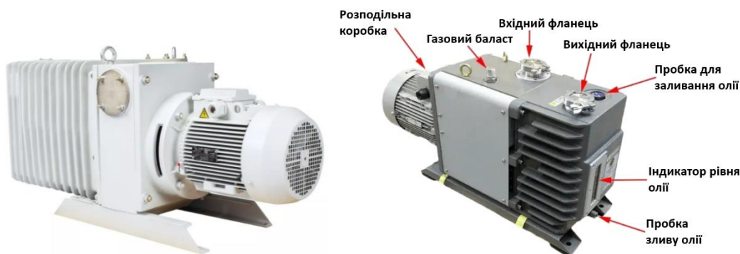
Рис. 1.12 Загальний вигляд роторно-пластинчастого вакуумного насоса типу 2HBP-250Д
