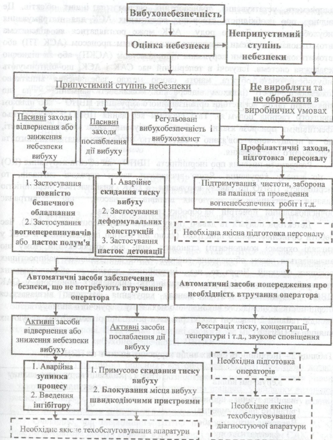
Рисунок 2 – Засоби для зниження вибухонебезпечності при виробництві, зберіганні й використанні горючих матеріалів
