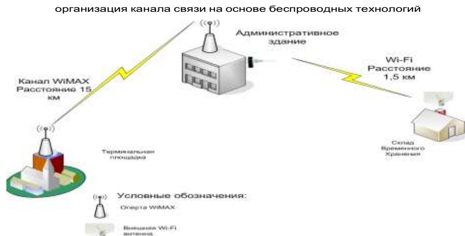
Рисунок 1.10 - Організація каналів зв'язку з використанням бездротових мережевих технологій
