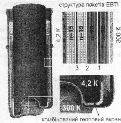
Рис.5. Оптимальна структура теплової ізоляції 100-канального МEG-криостата.
