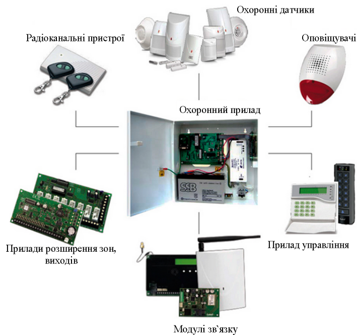
Рисунок 1.3 – Компоненты системы охранной сигнализации
