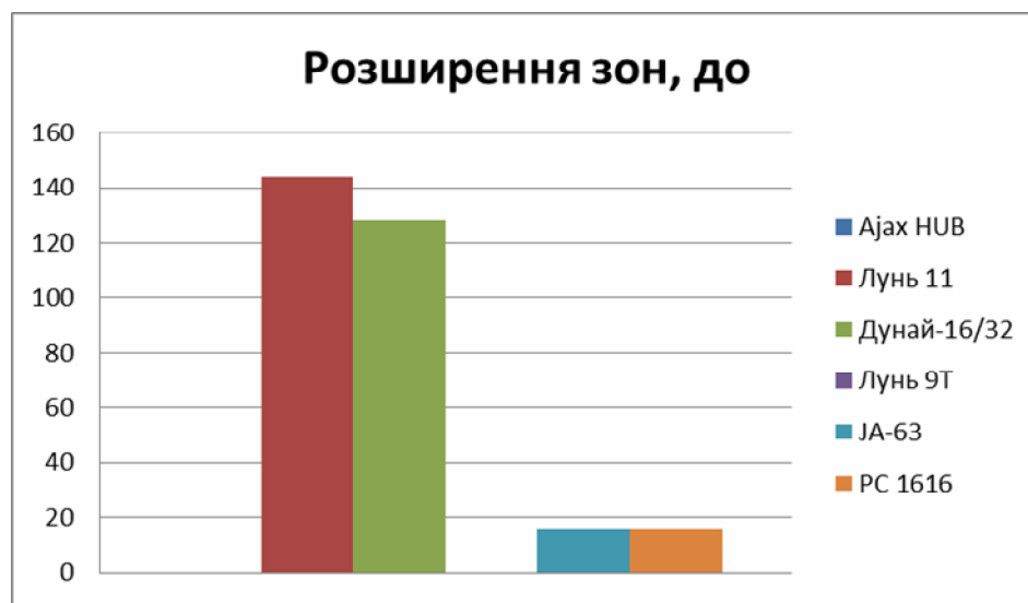
Рисунок 3.6 – Порівняння ППК за можливістю розширення зон
