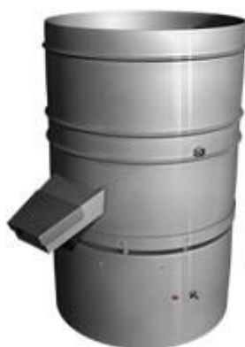
Рис 3.4 Борошнопросіювач вібраційний 150 кг/ч ВП-1
