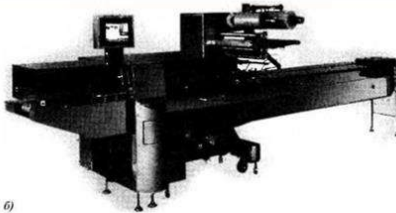
Рис. 4. Горизонтальна лінійна машина ГИ 3400/МВ (Японія) для пакування штучних виробів у тришовний полімерний пакет, а — схема процесу пакування, б — загальний вигляд
