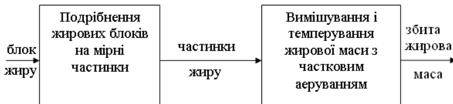
Рисунок 1 – Структурна схема технологічного процесу у ВВ-ПМЛ
