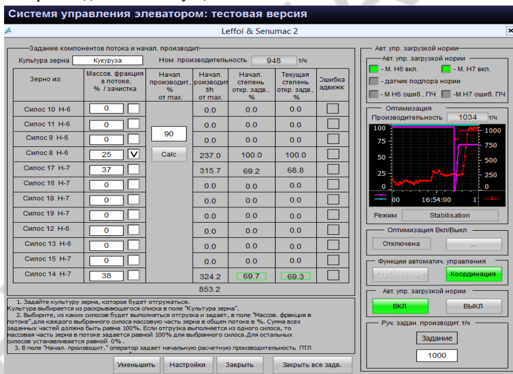
Рис. 1. Вид окна графического интерфейса оператора для его работы с АСОЗ.
