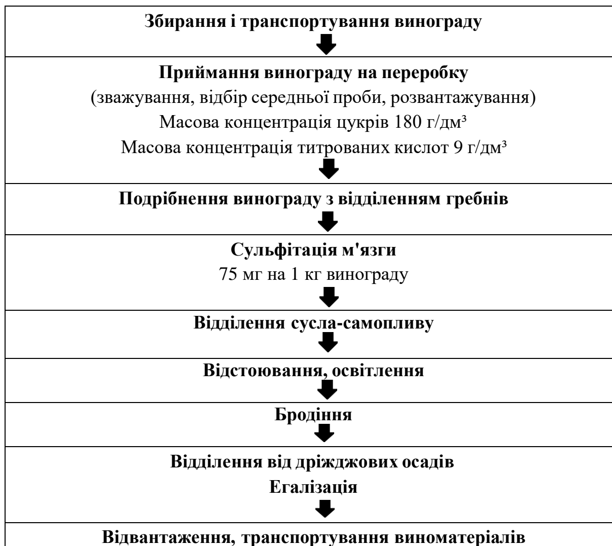
Рисунок 3.1 – Процесуальна схема виробництва виноматеріалів для білих ігристих вин
