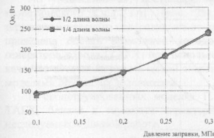
Рис. 21. Зависимость подводимой теплоты, необходимой для поддержания устойчивых колебаний, от давления заправки в случае \frac{1}{2} (полуволнового) и \frac{1}{4} (четвертьволнового) ТАГ. (Рабочее вещество – гелий).
