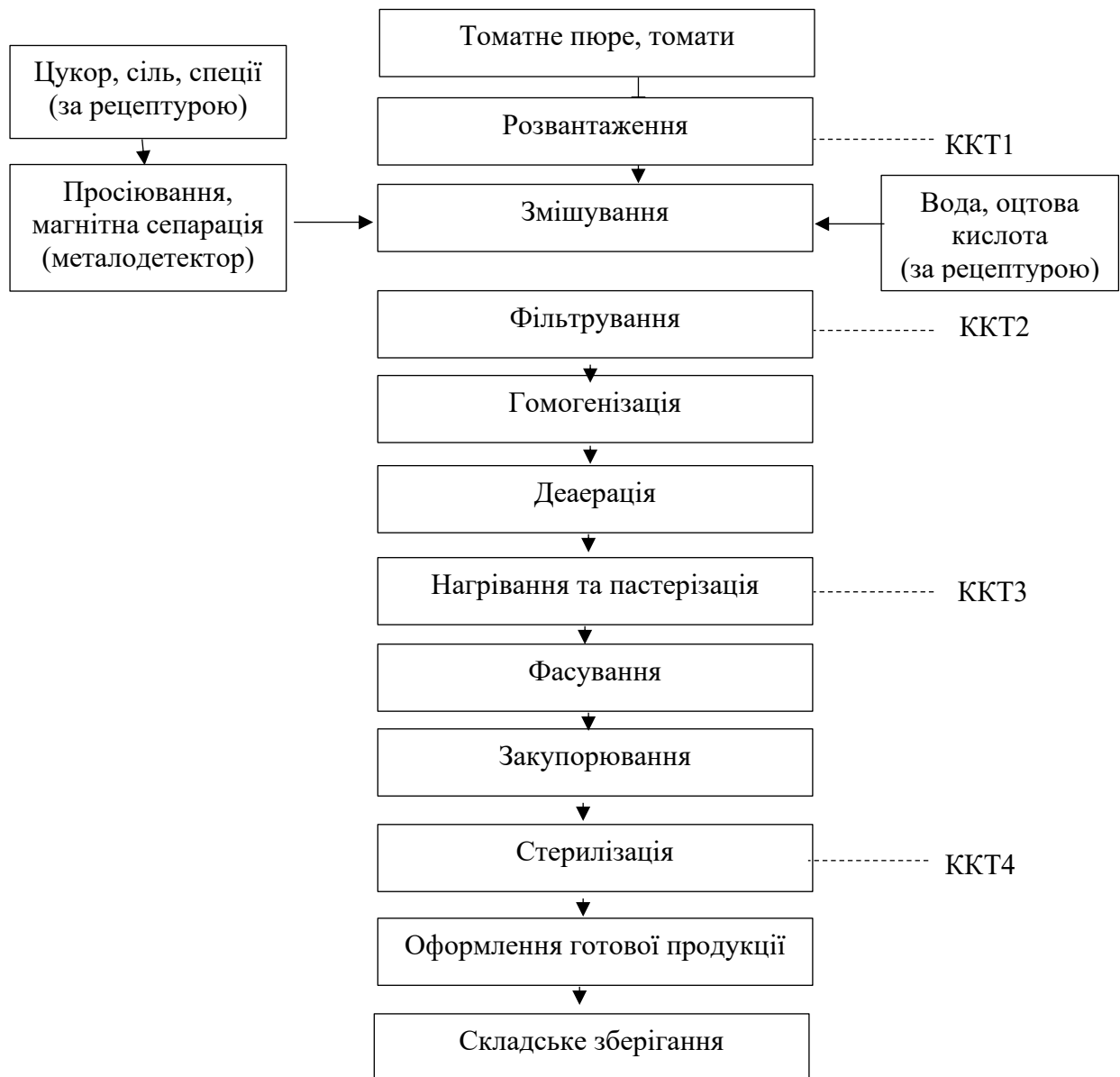
Рис. 1.1. Блок- схема виробництва томатного кетчупу з концентрованої томатної пасти
